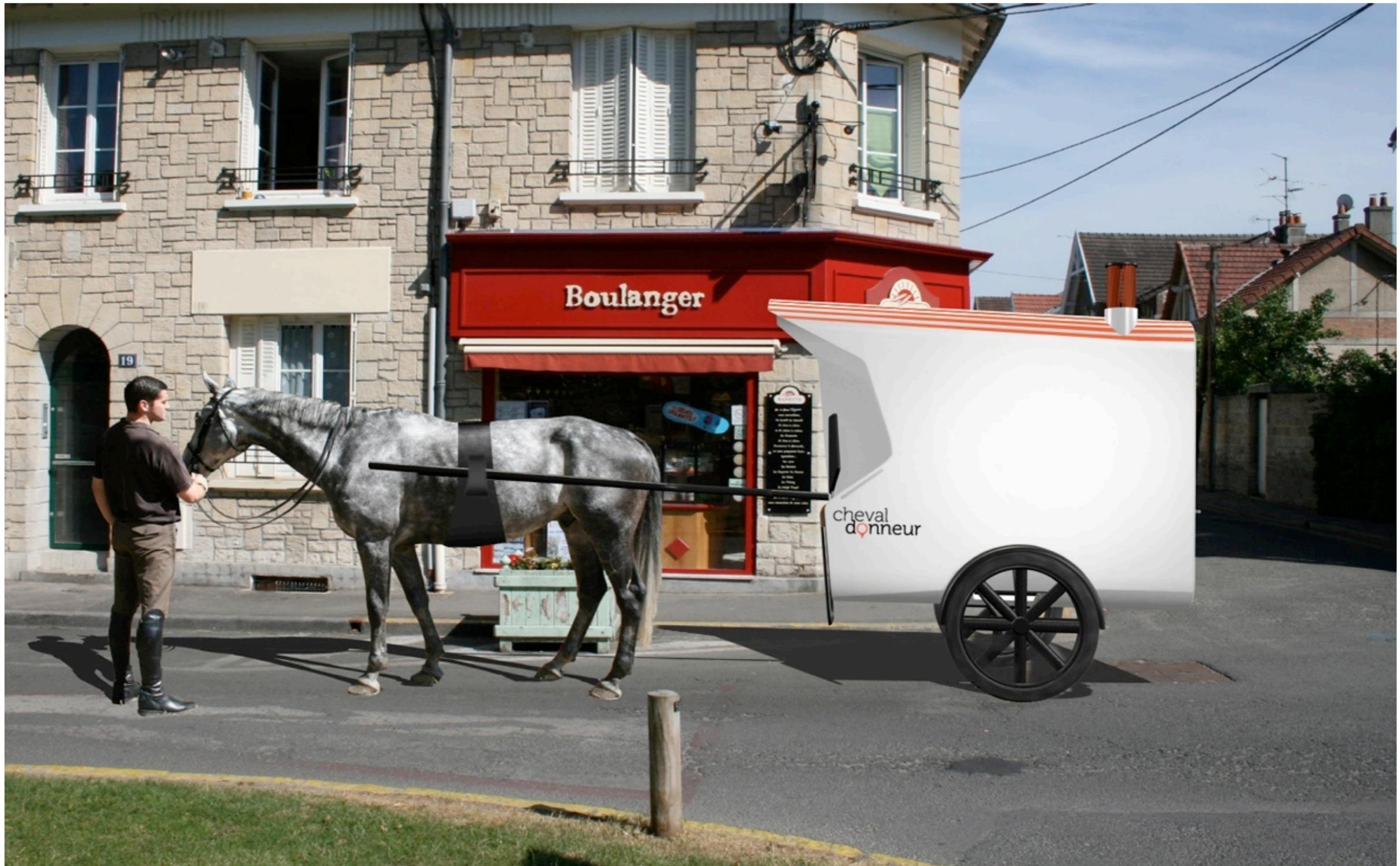
*L'hippomobile bénéficie de cellules de Grätzel (cellules à pigments photosensibles) ainsi que d'une éolienne qui permet de fournir l'électricité nécessaire au rétroviseur intelligent.*
